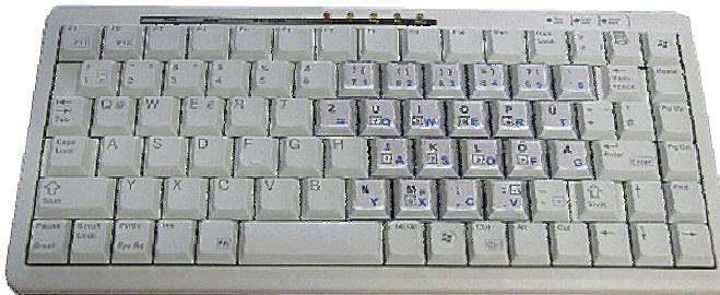
Wenn überwiegend mit aufgelegter Hand geschrieben werden soll, um Anstrengungen zu vermeiden oder die Hand zu beruhigen oder zusätzlich eine Sehbehinderung die schnelle Orientierung erschwert, muss das Tastenfeld kleiner werden, möglichst ohne Verkleinerung der Tastenköpfe. Dies wird mit der 1-Hand-Kompakt- und noch mehr mit der 1-Hand-Kleintastatur erreicht.
