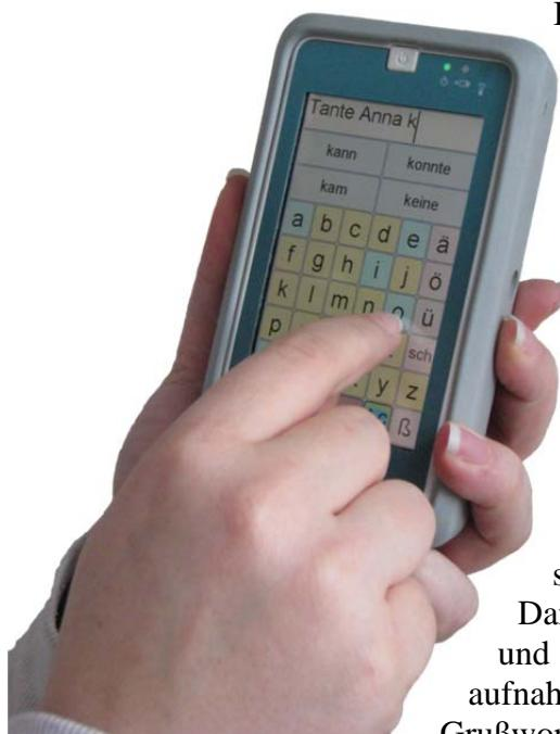
Das Gerät verfügt über einen lichtstarken kontrastreichen Bildschirm mit 10,9 cm Diagonale. Es wird mit einem Touchscreen ausgestattet, der mit Stift, Finger oder Fingernagel ausgelöst werden kann. Das Zeitverhalten lässt sich einstellen, um feinmotorische Störungen auszugleichen.
