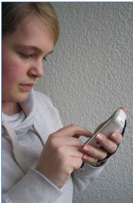
Ein sicherer Halt des Gerätes in der Hand ist durch ein Gummiband gegeben, welches bei der Benutzung mit oder ohne Gummischutzhülle zur Verfügung steht.
