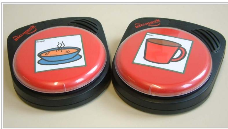
Durch Drücken der großen bunten Taste kann der Nutzer die Aussage beliebig oft abspielen. Es besteht zusätzlich die Möglichkeit, einen externen Schalter anzuschließen, um z.B. eine Auslösung mit anderen festmontierten Tastern zu ermöglichen.
